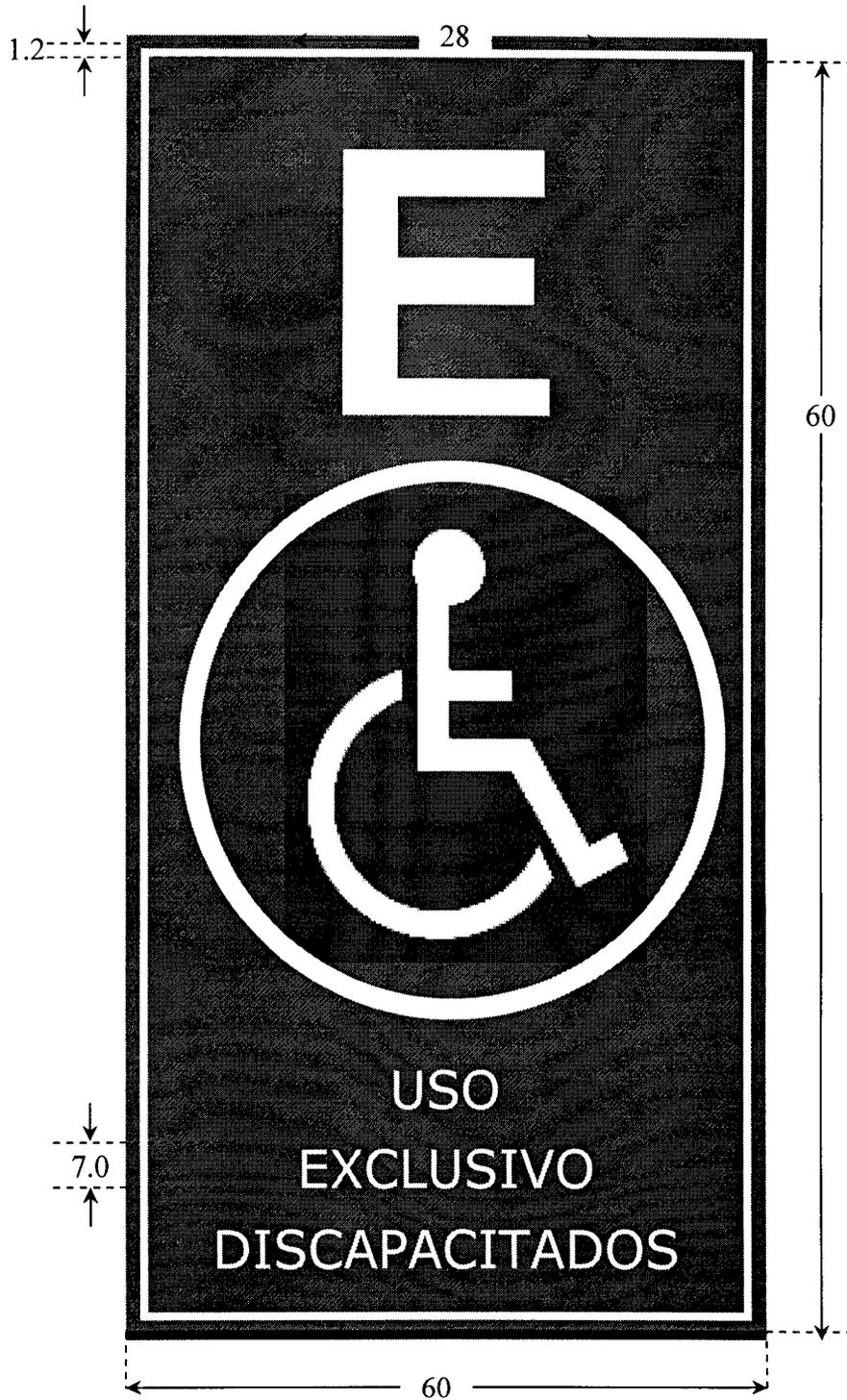
NOTA: Cotas en Centímetros. Letreros Metálicos con cinta reflectante (Ver Manual de Señalización de Tránsito)
